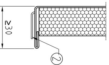
② Mit Profilnasenkröpfung zur Befestigung einer Wartungsklappe
