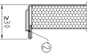
② Mit Profilnasenkröpfung zur Befestigung einer Wartungsklappe
